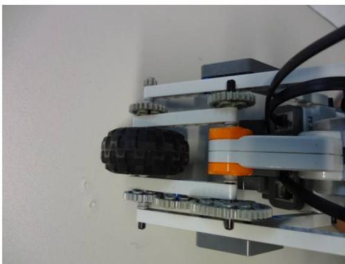
FIGURE 4.4 – Modèle final de la roue arrière
