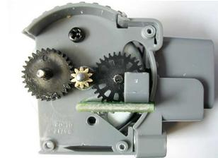
FIGURE 2.3 – Moteur NXT : capteur de rotation [10]
