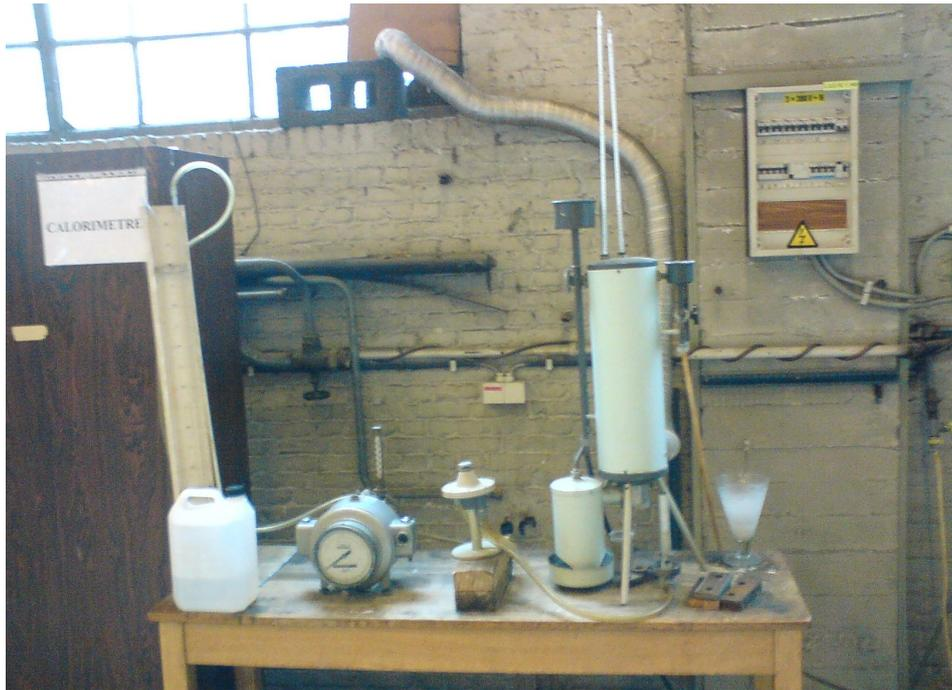
FIGURE 1.3. Le calorimètre de Junkers.
