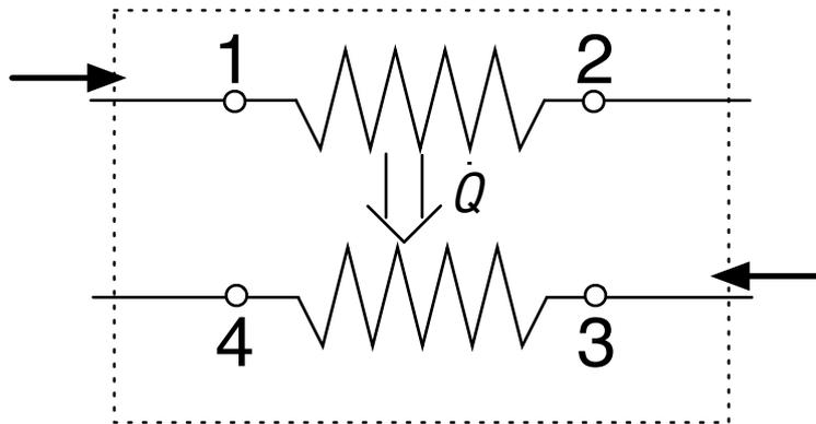
FIG. 1 – Echangeur de chaleur contre-courant
