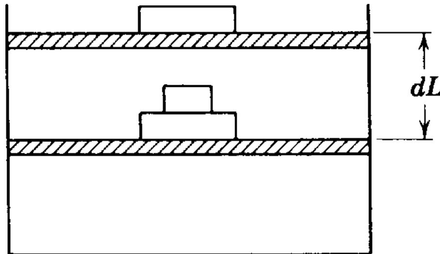
Imaginons qu'un poids infinitésimal soit retiré du piston. Il va dès lors se soulever d'une distance  $dL$ . Comme la force exercée par le gaz sur le piston vaut  $F = p\mathcal{A}$ , le travail fourni par le système au cours de ce déplacement vaut
