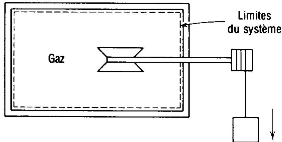
Le système considéré est constitué du contenu de l'enceinte. Lors du déplacement du poids, l'arbre tourne et du travail est reçu par le système, bien qu'il n'y ait aucune variation de volume. Le travail reçu est le produit du couple de torsion par l'angle de rotation à l'endroit où l'arbre est coupé par la frontière.
