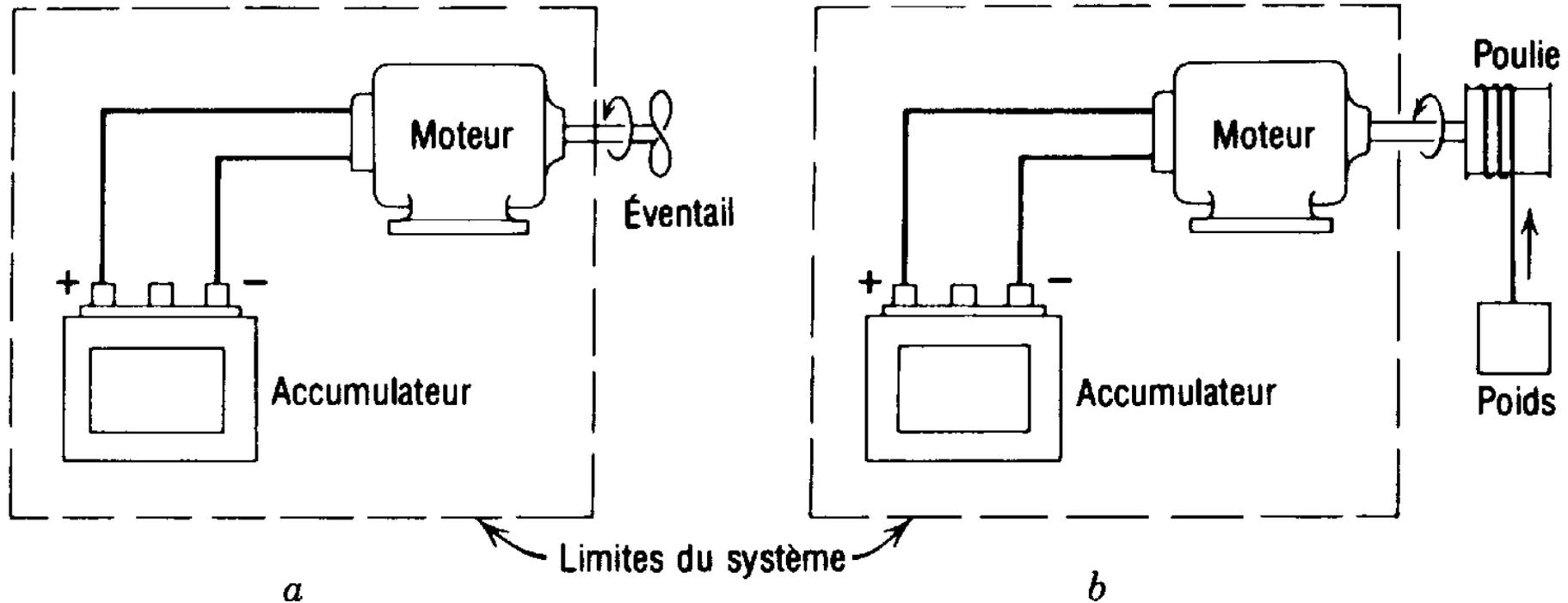
On remplace le ventilateur par une poulie à laquelle est suspendue un poids.
