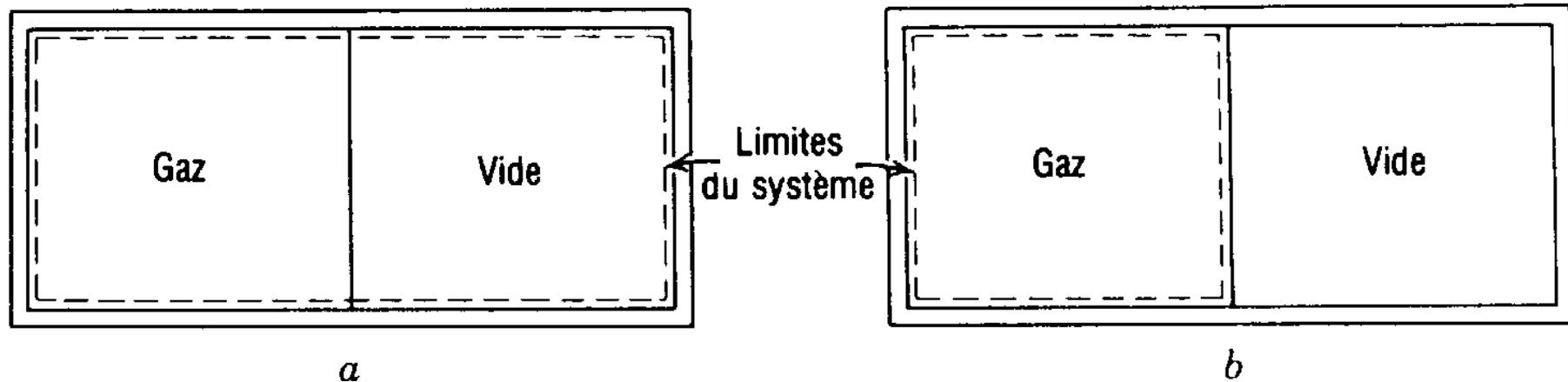
Lorsque la membrane se rompt, le gaz se répand dans la totalité du réservoir.
