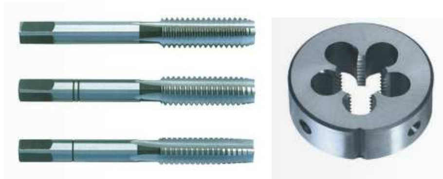
Exemple de taraud (à gauche) et de filière (à droite)
