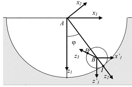
R1 lié à S1 tournant avec  $\dot{\alpha}$  :  $\bar{\omega}_{\text{cercle } S1} = \dot{\alpha} \bar{1}_z$
