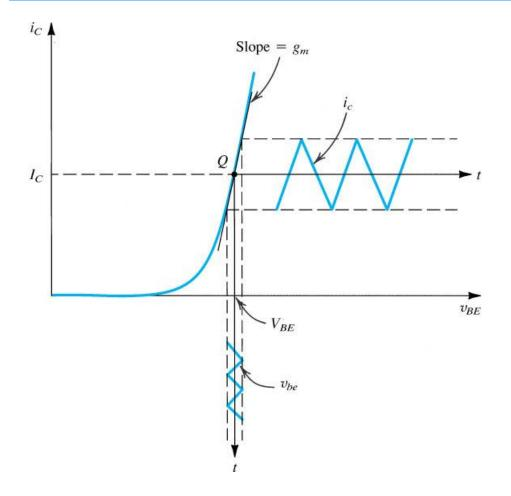
$$i_{C} = I_{C} e^{v_{be}/V_{T}}$$
