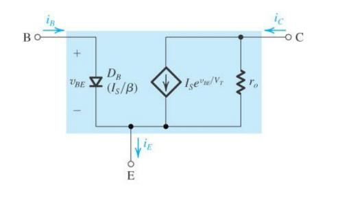
$$i_{C} = I_{S} e^{\nu_{BE}/V_{T}}$$
