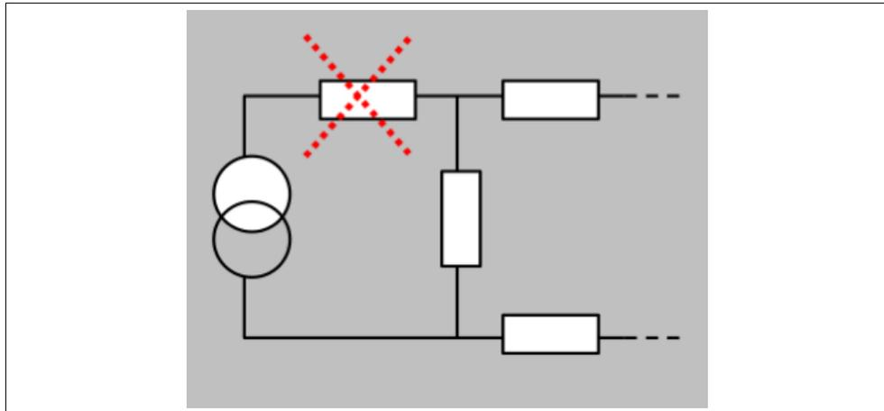
FIGURE 3.15 – une résistance en série avec une source de courant peut être remplacée par un court-circuit
