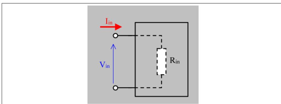
FIGURE 4.7 – Modélisation de l'entrée d'un appareil par son équivalent de Thévenin (résistance d'entrée)
