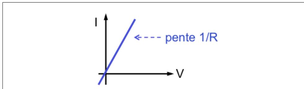
FIGURE 2.4 – caractéristique d'une résistance dans le plan (I,V)
