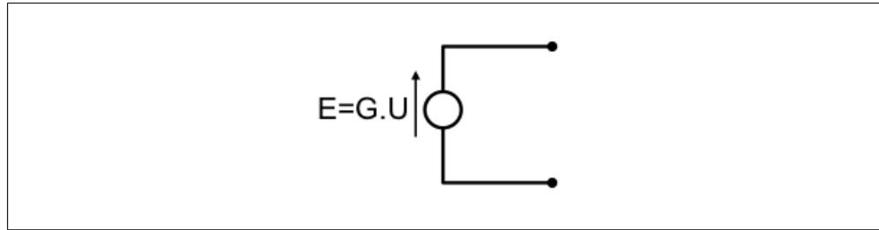
FIGURE 2.17 – source de tension commandée en tension, vue comme un dipôle
