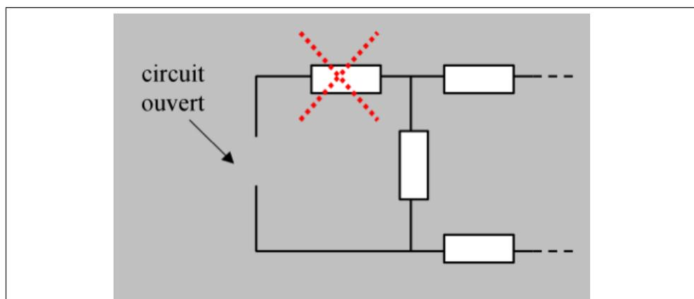
FIGURE 3.16 – suppression d'une branche interrompue
