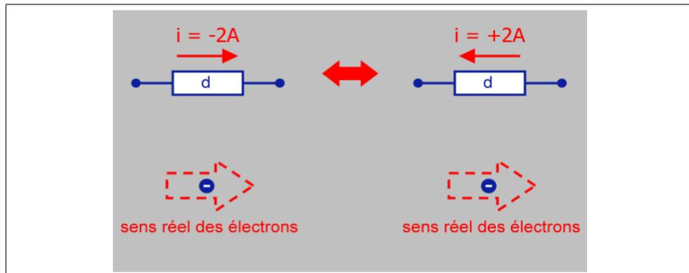
FIGURE 1.11 – Pour se débarrasser du signe "-" d'une intensité négative, il suffit d'inverser simultanément le signe de l'intensité *et* le sens de la flèche de courant qui lui est associée.
