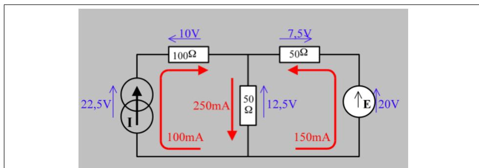
FIGURE 3.5 – exemple de solution numérique
