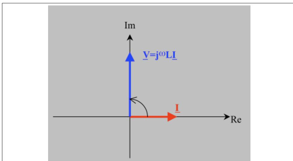
FIGURE 5.8 – phaseurs de tension et de courant d'une inductance pure
