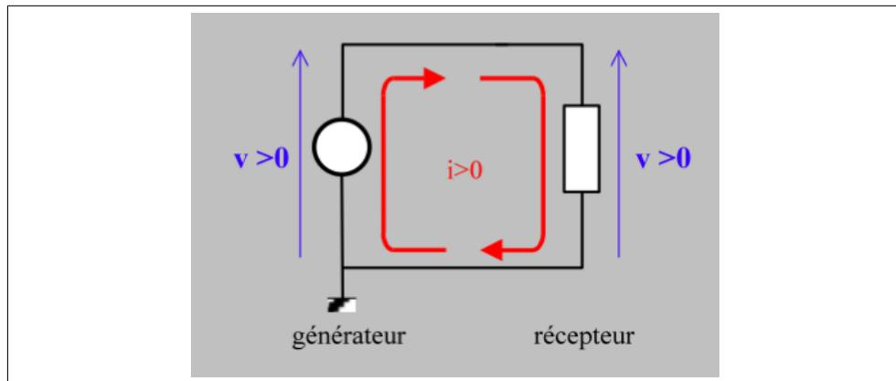
FIGURE 1.26 – signes de la tension et du courant dans un circuit complet
