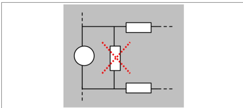
FIGURE 3.14 – une résistance en parallèle sur une source de tension peut être supprimée
