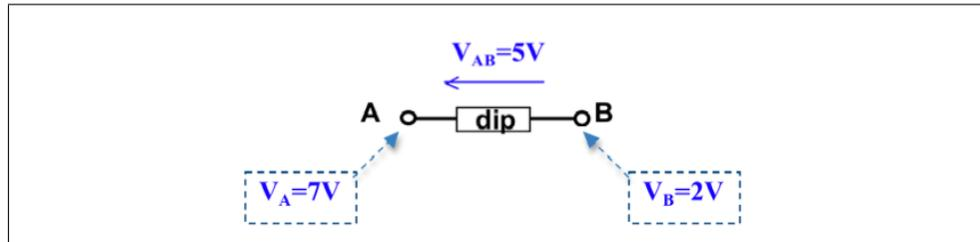
FIGURE 1.13 – Représentation des potentiels aux nœuds A et B (convention propre à ce cours)
