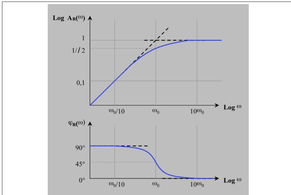
FIGURE 6.5 – courbes de Bode de la réponse en fréquence d'un filtre passe-haut du 1er ordre
