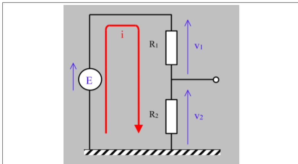
FIGURE 3.10 – courants et tensions choisis pour résoudre le circuit (étapes 1 et 2)
