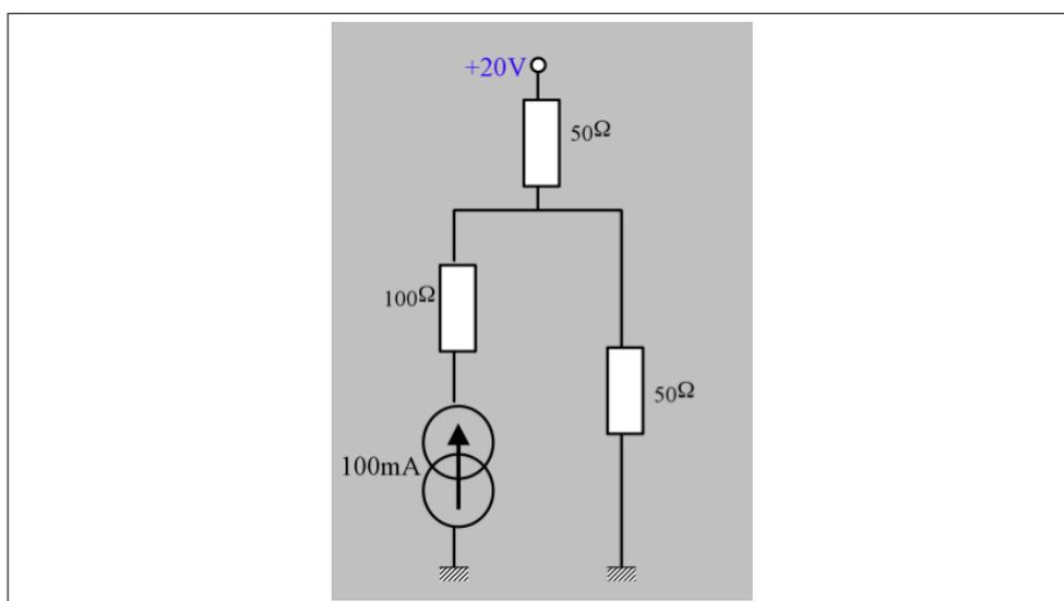
FIGURE 3.6 – notation allégée utilisée pour les alimentations (à comparer à la figure 3.2)
