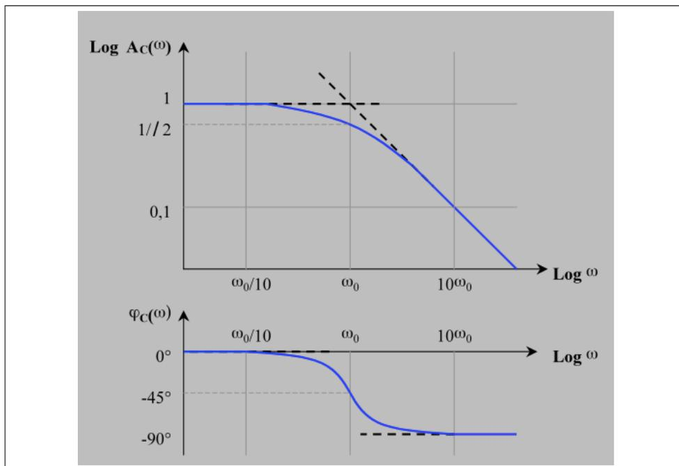
FIGURE 6.6 – Courbes de Bode de la réponse en fréquence d'un filtre passe-bas du 1er ordre
