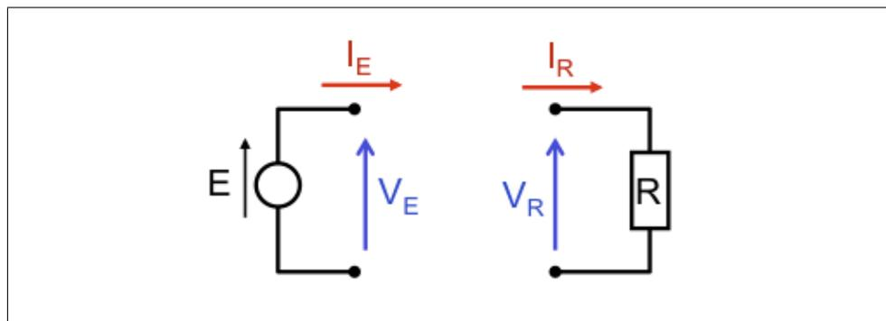
FIGURE 3.18 – le même circuit divisé en deux demi-circuits, avec les conventions adéquates
