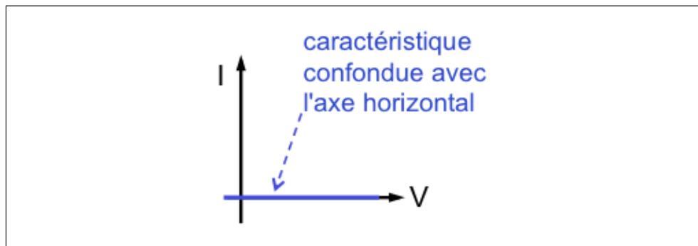
FIGURE 2.14 – caractéristique d'un circuit ouvert
