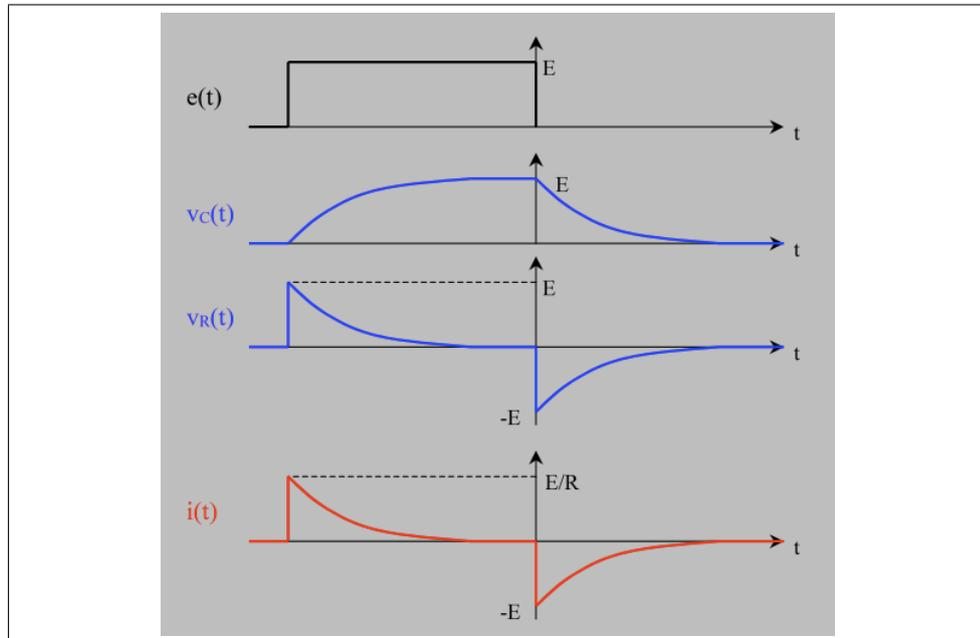
FIGURE 5.4 – formes d'onde d'un RC pour un échelon de tension négatif (en  $t=0$ )
