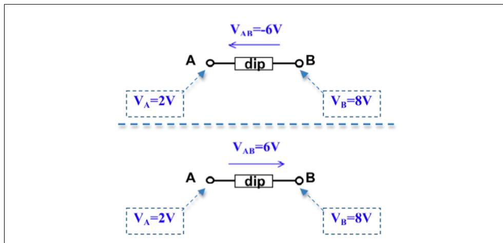
FIGURE 1.14 – Inversion d'une ddp négative (à noter : les potentiels restent inchangés)
