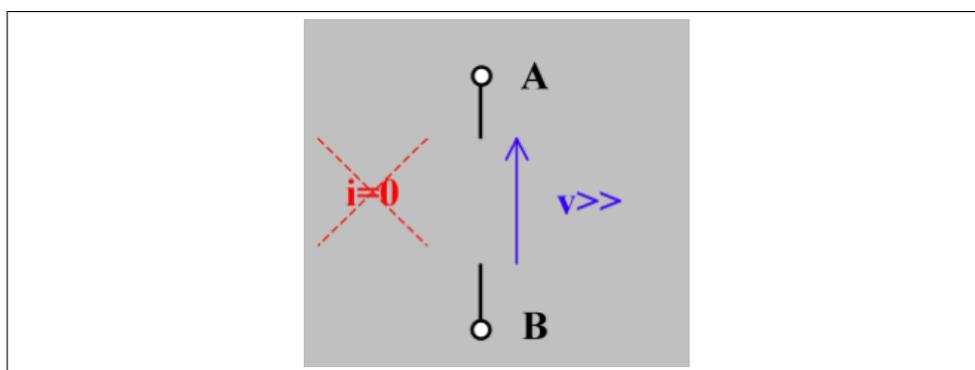
FIGURE 2.15 – circuit ouvert (équivalent à une résistance infinie)
