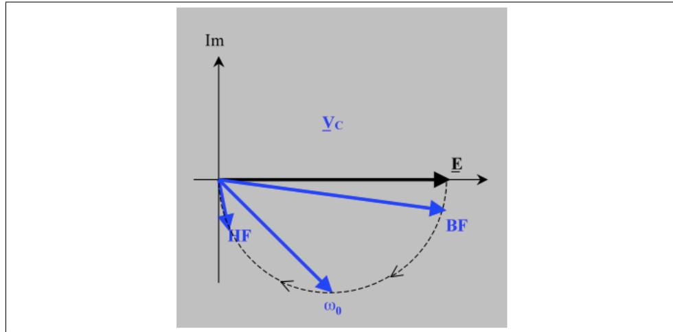
FIGURE 6.4 – évolution du phaseur de tension sur la capacité en fonction la fréquence
