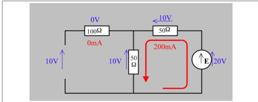
FIGURE 3.20 – sous-circuit obtenu en supprimant la source de courant
