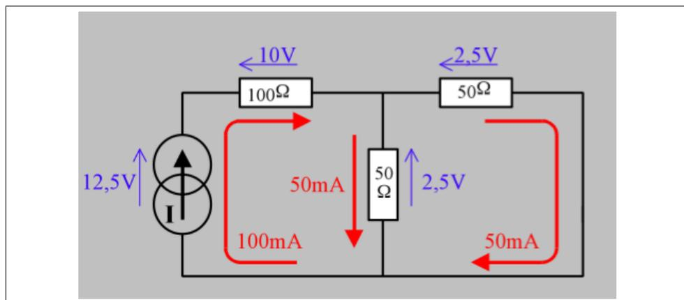
FIGURE 3.21 – sous-circuit obtenu en supprimant la source de tension
