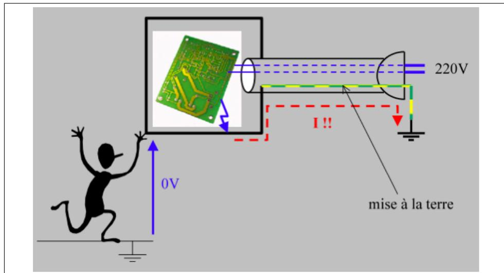
FIGURE 1.22 – Cas d'un appareil mis à la terre et présentant un défaut : l'utilisateur voit une différence de potentiel nulle (pas d'électrocution).
