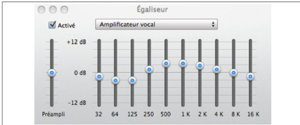
FIGURE 5.13 – copie d'écran de l'égaliseur dans iTunes. Le profil sélectionné ici a pour but de faire ressortir la voix humaine, typiquement entre 250Hz et 4kHz
