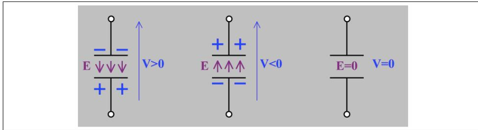
FIGURE 5.1 – capacité chargée positivement (gauche), négativement (centre) et déchargée (droite)
