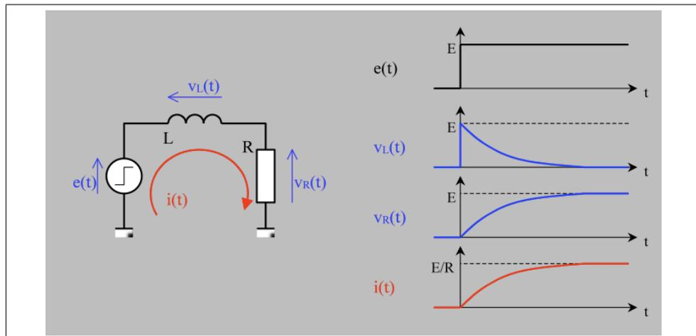
FIGURE 5.5 – évolution des grandeurs électriques dans le circuit RL (échelon de tension)
