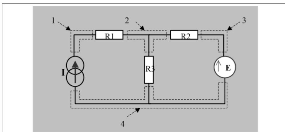
FIGURE 3.1 – Le circuit ci-dessus possède 4 noeuds (lignes interrompues)
