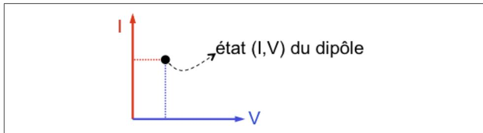
FIGURE 2.1 – état électrique d'un dipôle dans le plan  $(I, V)$
