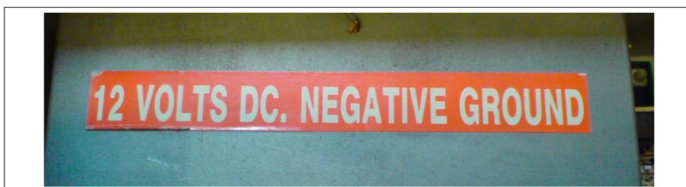
FIGURE 1.24 – Détail de l'autocollant visible sur l'autoradio de la figure précédente : la mention d'une terre "négative" ("negative ground") montre bien que la terre n'est pas toujours à 0V
