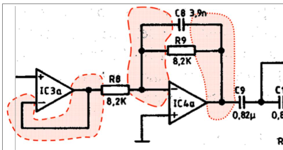
FIGURE 1.4 – Exemples de nœuds dans un schéma (image de fond d'après G. Haas, "Sono & Studio : équipement électronique sur mesure", Publitrone/Elektor, 1998)
