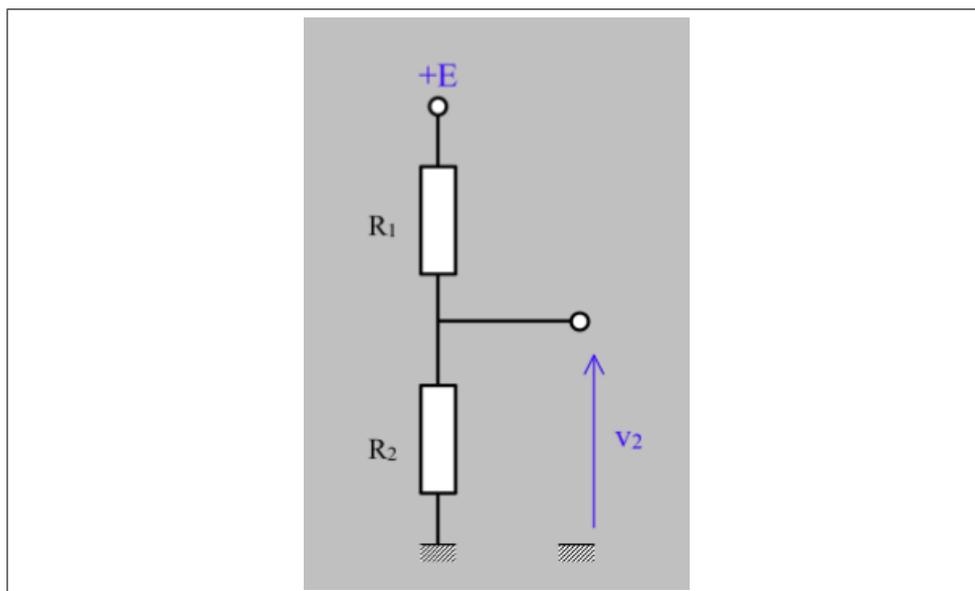
FIGURE 3.8 – schéma du diviseur résistif
