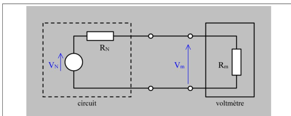
FIGURE 4.15 – modélisation d'une mesure au voltmètre
