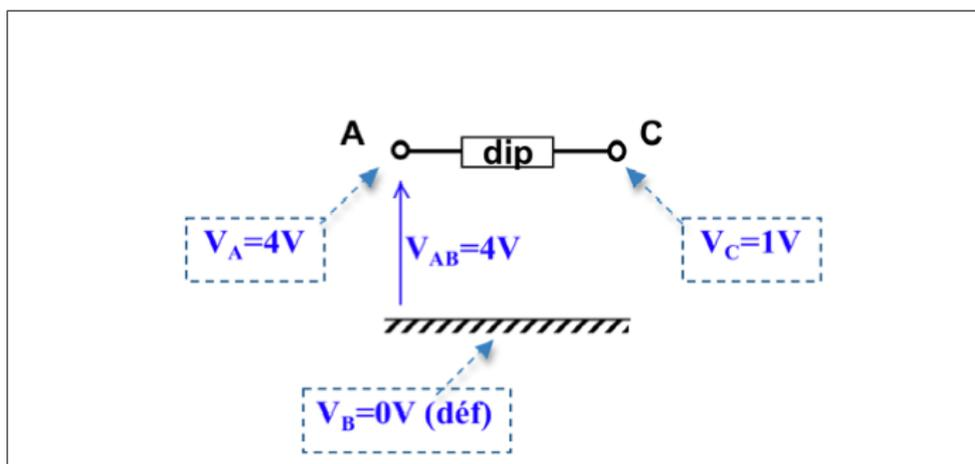
FIGURE 1.16 – Cas particulier d’une ddp relative à la masse :  $V_{AB} = V_A$
