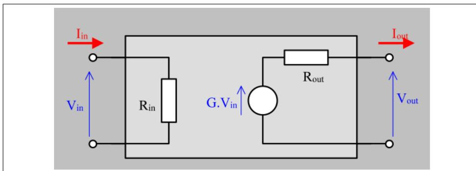
FIGURE 4.11 – schéma équivalent (Thévenin) d'un amplificateur tension-tension
