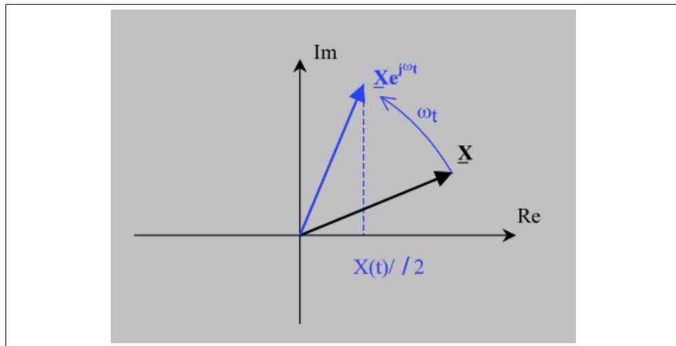
FIGURE 5.7 – lien entre phaseur (fixe) et signal temporel (tpériodique)
