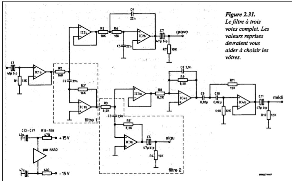
FIGURE 1.1 – Schéma d'un filtre à trois voies (d'après G. Haas, "Sono & Studio : équipement électronique sur mesure", Publitrone/Elektor, 1998)
