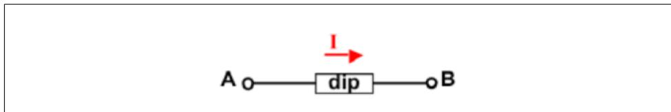
FIGURE 1.8 – Représentation du courant conventionnel
