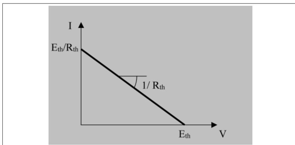
FIGURE 4.2 – caractéristique de l'équivalent de Thévenin de la figure 4.1
