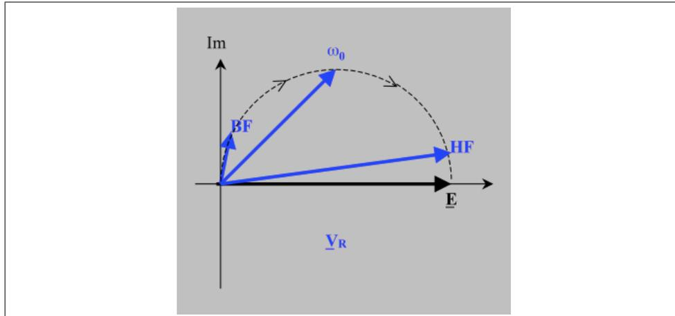
FIGURE 6.3 – évolution du phaseur de tension sur la résistance en fonction la fréquence
