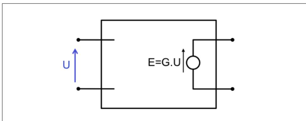
FIGURE 2.16 – source de tension commandée en tension, vue comme un quadripôle
