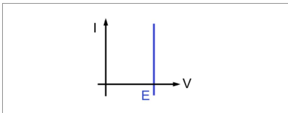
FIGURE 2.9 – caractéristique d'une source de tension idéale
