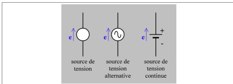
FIGURE 2.8 – symboles d'une source de tension idéale
