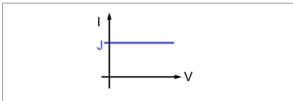
FIGURE 2.11 – caractéristique d'une source de courant idéale
