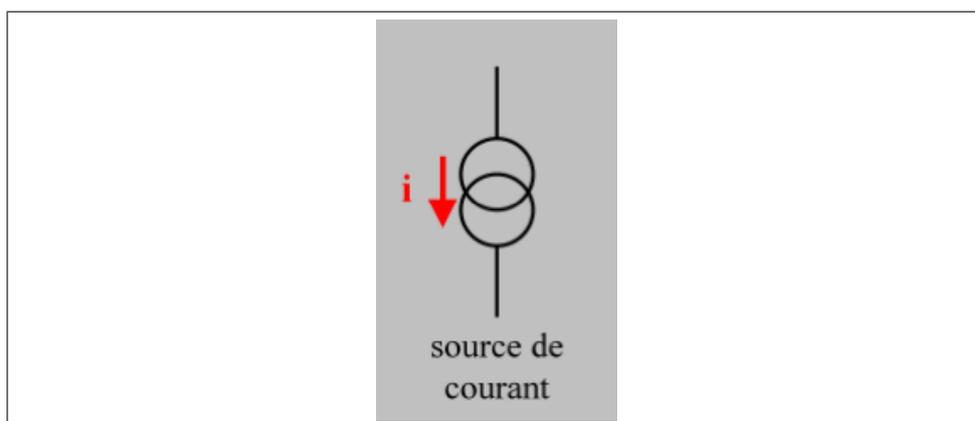
FIGURE 2.10 – symbole d'une source de courant
