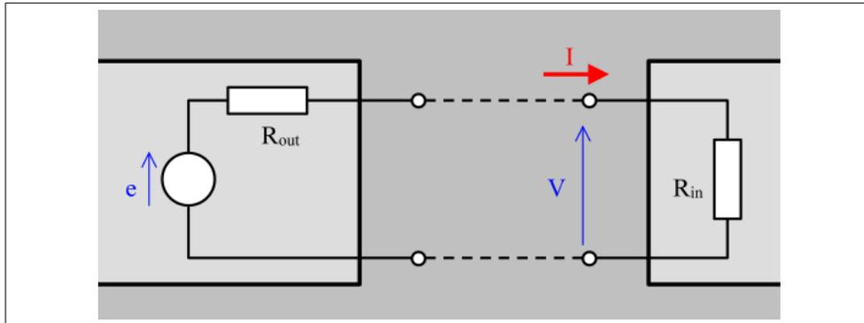
FIGURE 4.12 – connexion entre deux appareils (sortie en tension)
