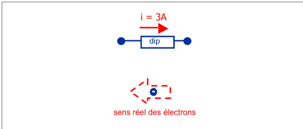
FIGURE 1.9 – La flèche de courant (au-dessus) désigne le sens de déplacement de charges positives (=courant conventionnel). Pour une intensité positive (ici 3A), les électrons vont donc en réalité dans le sens inverse de la flèche.
