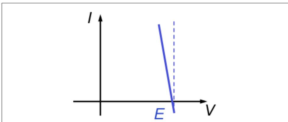
FIGURE 4.9 – influence de la résistance de sortie sur la caractéristique d'une source de tension
