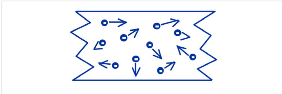
FIGURE 1.5 – Mouvement aléatoire des électrons : le déplacement moyen est nul, donc le courant également
