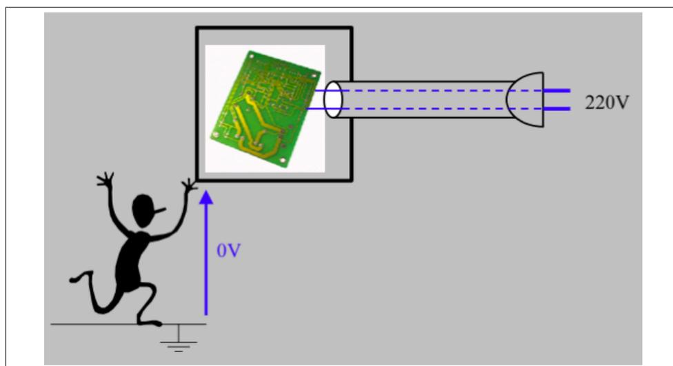
FIGURE 1.20 – Cas d'un appareil non mis à la terre et sans défaut : c'est l'utilisateur qui impose son potentiel au châssis lorsqu'il le touche (pas d'électrocution).
