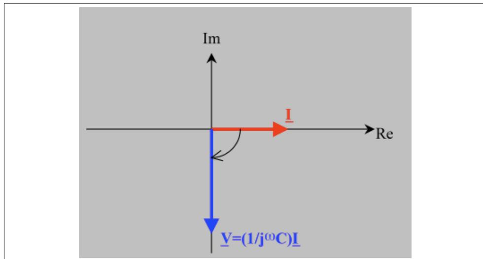
FIGURE 5.9 – phaseurs de tension et de courant d'une capacité pure
