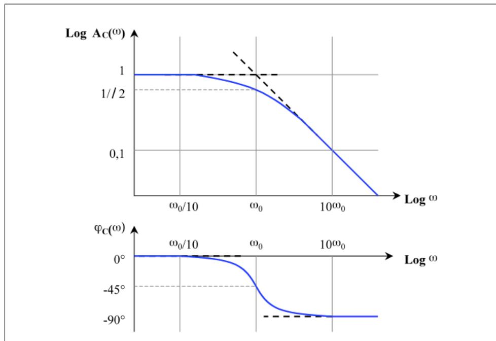
FIGURE 5.12 – réponse en fréquence d'un circuit passe-bas du 1er ordre
