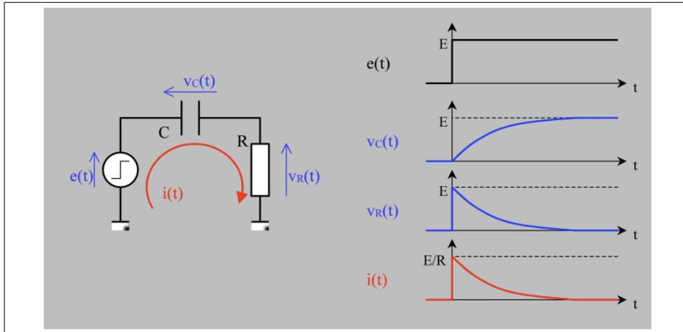
FIGURE 5.3 – évolution des grandeurs électriques dans le circuit RC (échelon de tension)
