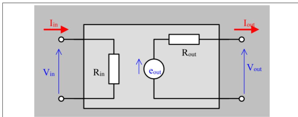
FIGURE 4.10 – schéma équivalent (Thévenin) d'un appareil comprenant une entrée et une sortie
