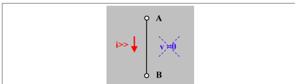
FIGURE 2.13 – Court-circuit (équivalent à une résistance nulle)
