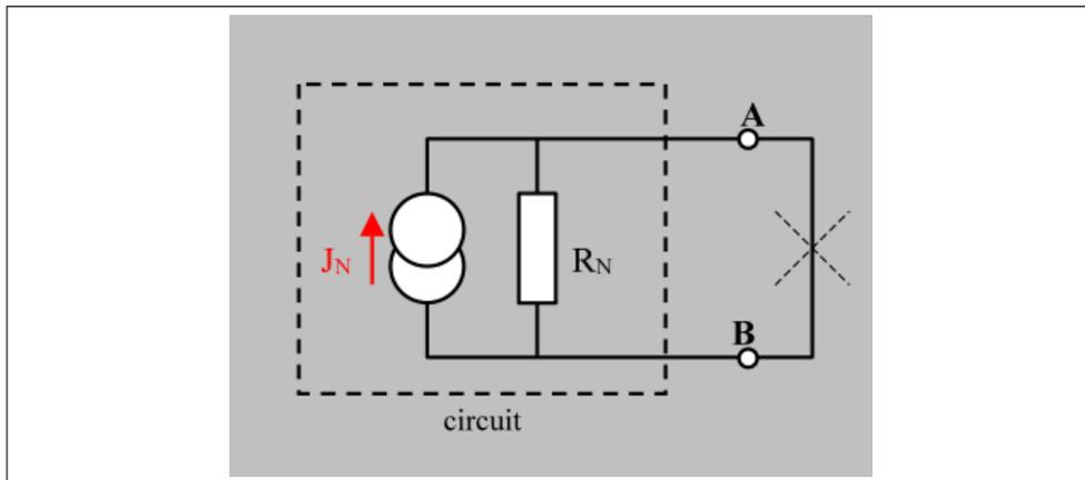
FIGURE 4.16 – équivalent de Norton du circuit où l'on insère un ampèremètre
