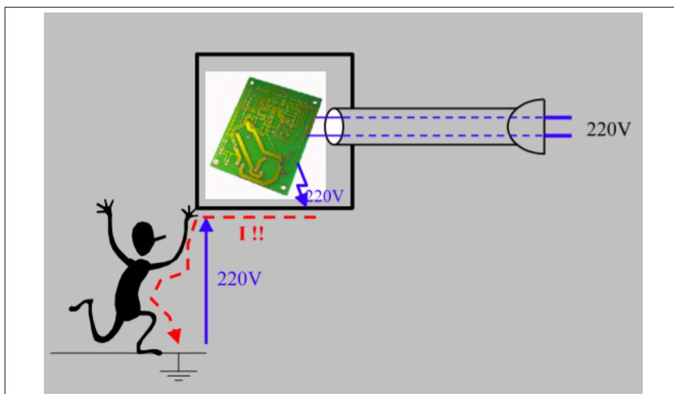
FIGURE 1.21 – Cas d'un appareil non mis à la terre et présentant un défaut : l'utilisateur voit une différence de potentiel de 220V (électrocution).
