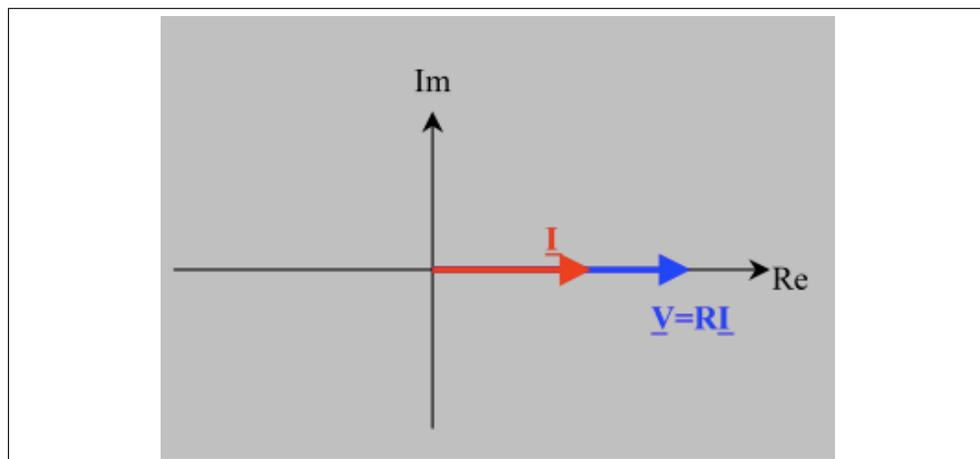
FIGURE 5.10 – phaseurs de tension et de courant d'une résistance pure
