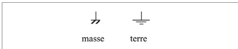
FIGURE 1.18 – Symboles de la masse et de la terre (mettre aussi le triangle)
