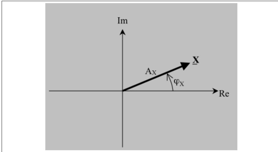
FIGURE 5.6 – représentation d'un phaseur dans le plan complexe
