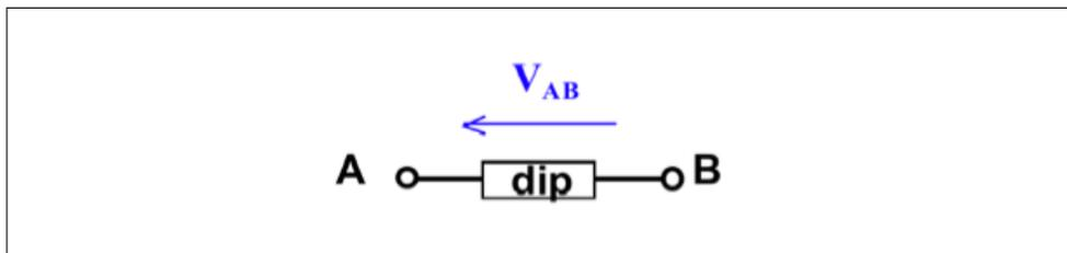
FIGURE 1.12 – Représentation de la différence de potentiel ( $V_{AB}$ ) entre les nœuds A et B
