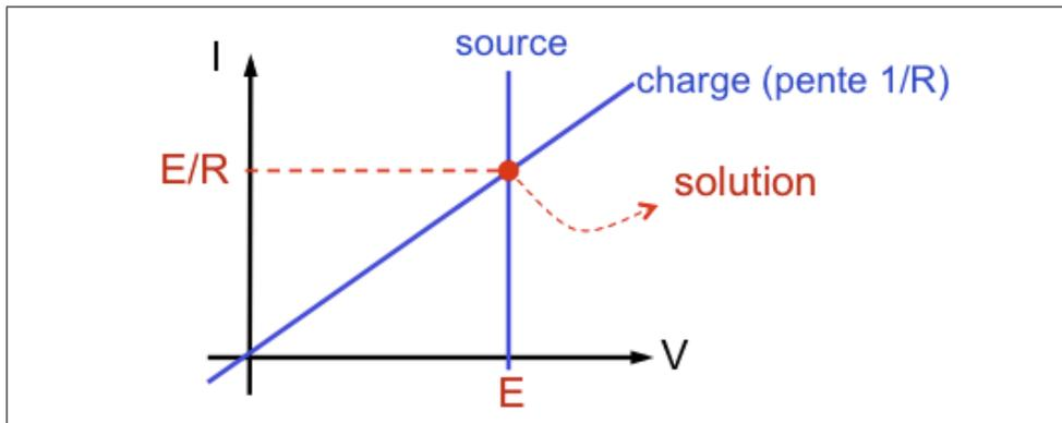
FIGURE 3.19 – résolution graphique par intersection des caractéristiques de deux demi-circuits
