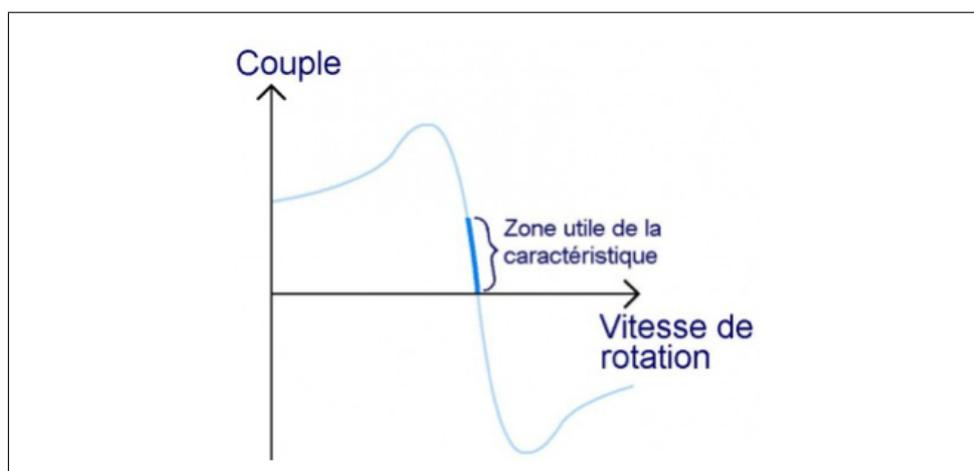
FIGURE 2.3 – exemple de caractéristique d'un moteur électrique asynchrone : la caractéristique décrit le lien entre *couple* et *vitesse de rotation*
