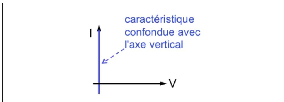
FIGURE 2.12 – caractéristique court-circuit
