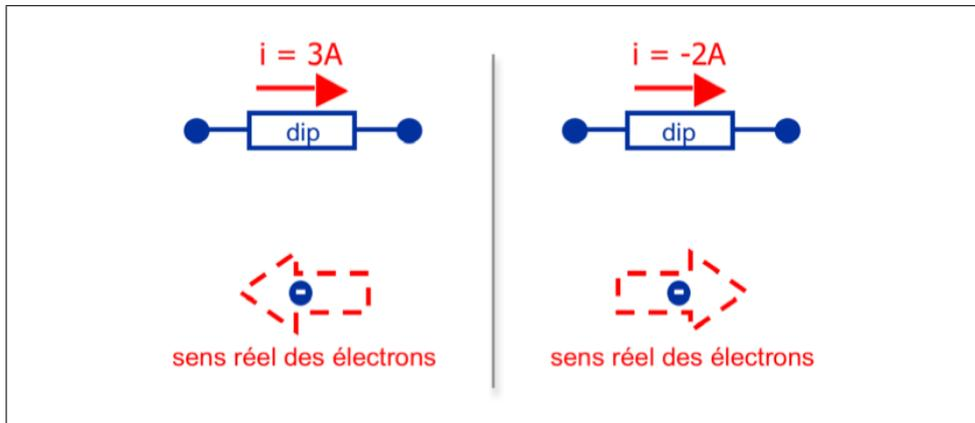
FIGURE 1.10 – La flèche de courant (au-dessus) désigne le sens de déplacement de charges positives (=courant conventionnel). Pour une intensité négative, les électrons vont donc en réalité dans le même sens que la flèche.
