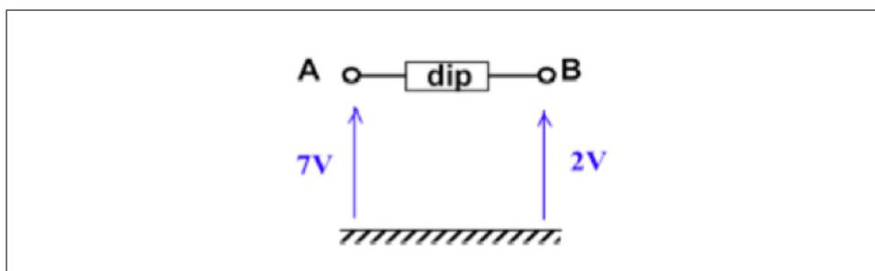
FIGURE 1.17 – Représentation des potentiels aux nœuds A et B (convention propre à ce cours)
