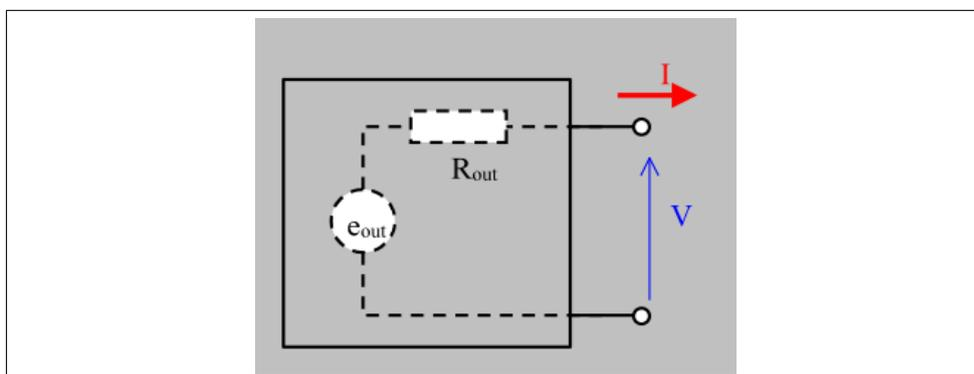
FIGURE 4.8 – Modélisation de la sortie d'un appareil par son équivalent de Thévenin (f.e.m. et impédance de sortie)
