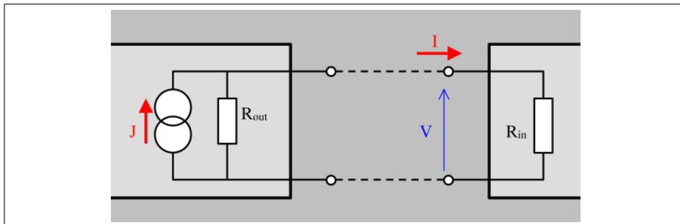
FIGURE 4.13 – connexion entre deux appareils (sortie en courant)
