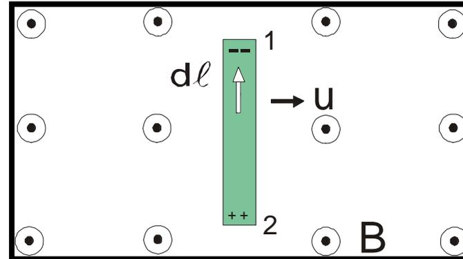
⇒ champ électrique  $\vec{E}_{es}$  (de type électrostatique) tel que la force électrique compensera exactement la force magnétique :
