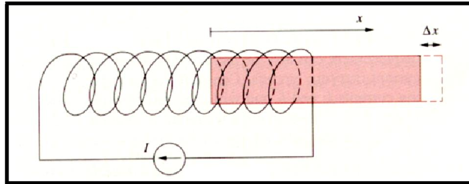
Un barreau ferromagnétique est attiré vers l'intérieur du solénoïde par les forces magnétiques.
