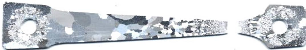
Figure 4.15 : microstructure d'une éprouvette d'aluminium déformée jusqu'à rupture et traitée thermiquement (1h15 à 620°C).
