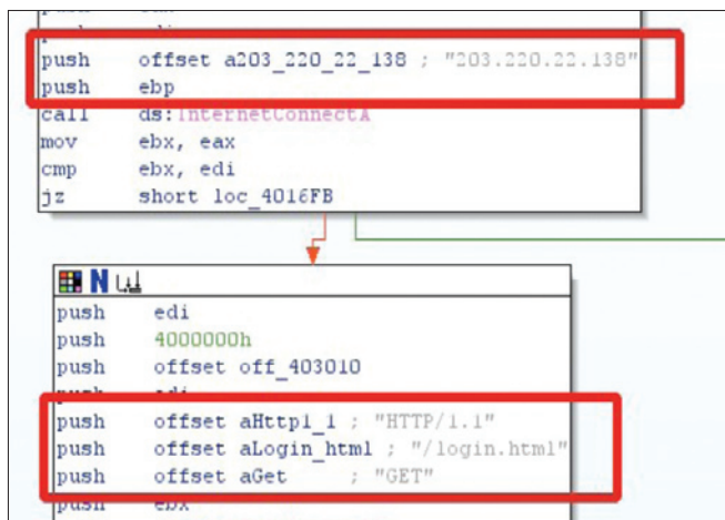
Figure 8. Cheval de troie contactant un serveur hard-coded pour les commandes
